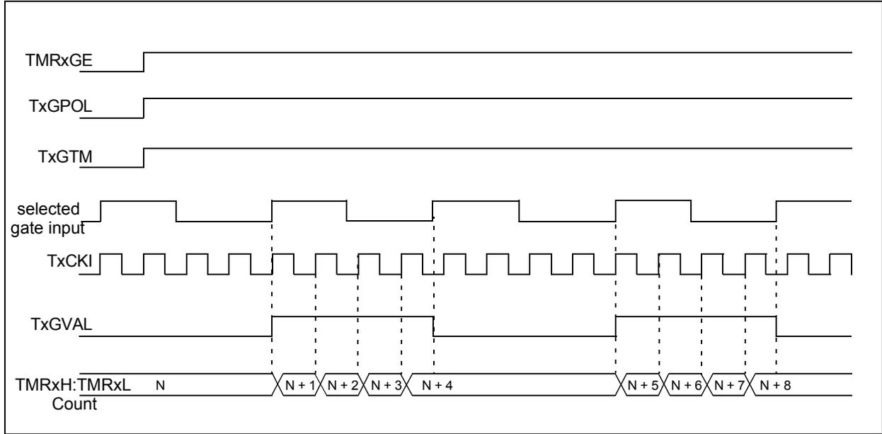
**FIGURE 28-5: TIMER1 GATE SINGLE-PULSE MODE**
